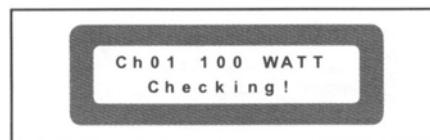
появляется надпись "проверка" ("CHECKING"). После окончания проверки, на дисплее появляется детальная информация и сравнение с предыдущими данными. Расхождения между новыми данными и предыдущими сохраненными данными, появляются на дисплее.
